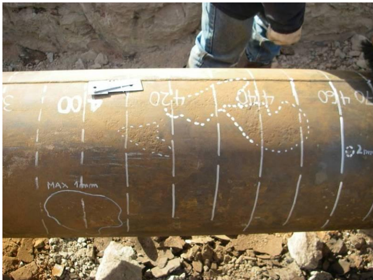
A 3,90 a 4,10 metros a las 3:00 Horas (Área diámetros 15 centímetros) Profundidad máxima 1,0 milímetros.
